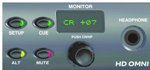
Monitoring-Bedienelemente und Kopfhöreranschluss
