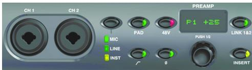
MIC/LINE/DI-Eingänge für Kanal 1 und 2 (CH 1 und CH 2) und Bedienelemente für Vorverstärker
