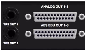
Rückseite: analoge Klinkenausgänge und analoge und digitale DB-25-Ausgänge (AES/EBU)
