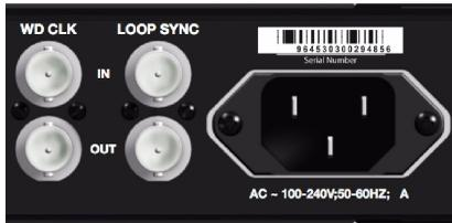
**Word Clock- und Loop Sync-Ein- und Ausgänge an der Rückseite**
