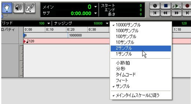
Figure 3: ナッジ値を少ないサンプル設定にしておくと、レーテンシー補正のためトラックをタイムライン上で移動/ナッジする作業が簡単に行えます。
