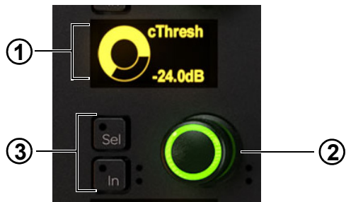
OLED (1)、旋钮 (2) 以及旋钮的切入和选择开关 (3)
