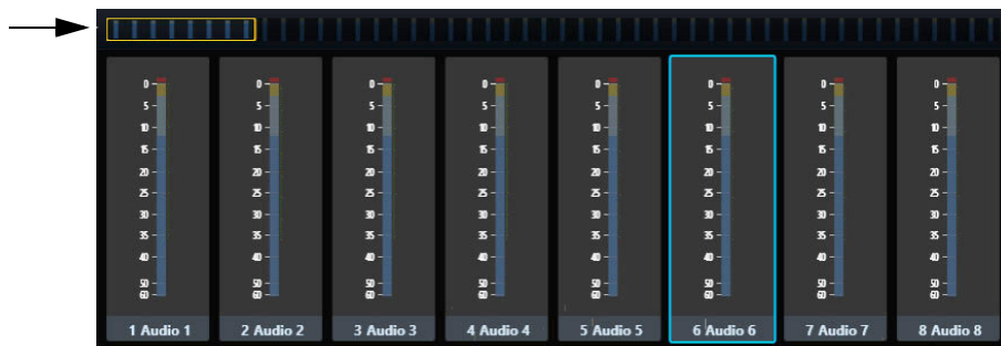
图 21 有通用条栏的电平表滚动器；音频 6 是关注轨道
