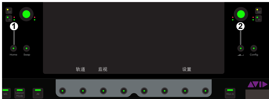
图 31 主屏幕 (1) 和后退 (2) 开关
