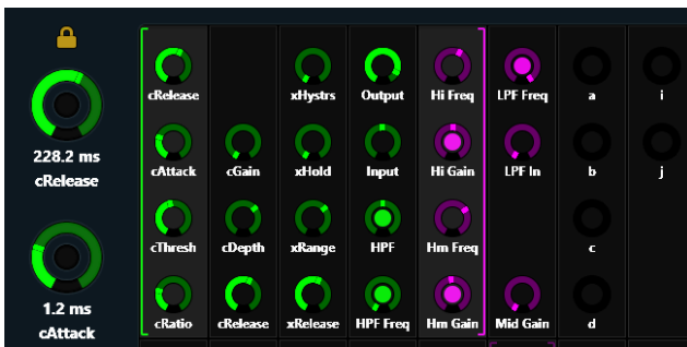
图 30 有括号的功能编辑器，指示哪些参数是分配给左侧（绿色）和右侧（紫色）关注轨道旋钮的。
