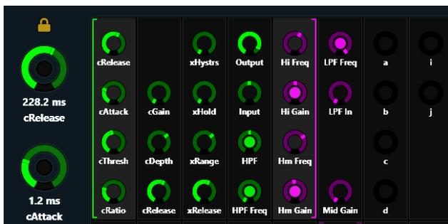
Figure 30. Éditeur de fonction avec crochets indiquant quels paramètres sont assignés aux boutons de gauche (vert) et de droite (violet) de la piste Attention
