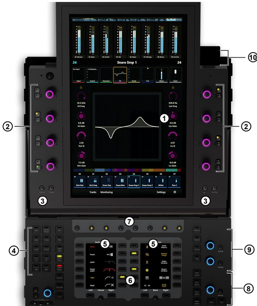
Abbildung 28. Bedienelemente und Anzeigen im Master-Modul
