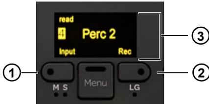
Input-Schalter (1), Record-Schalter (2), OLED (3)
