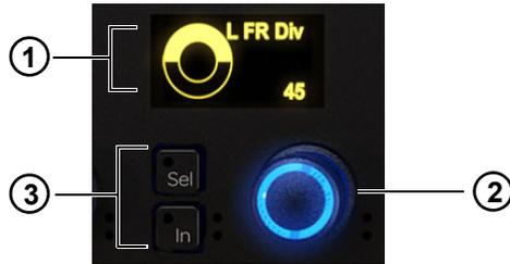
OLED (1), Drehregler (2) und In- und Sel-Schalter (3) für den Regler
