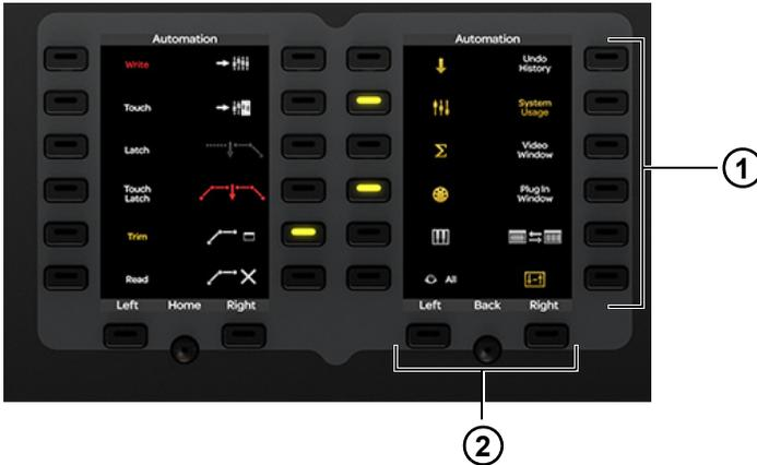
Soft Key-Sektion mit Soft Keys (1) und Navigationsschaltern (2)
