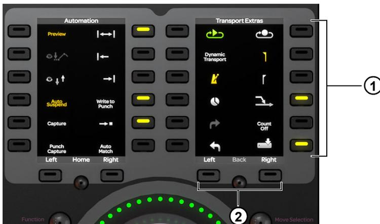
Soft Key-Sektion mit Soft Keys (1) und Navigationsschaltern (2)
