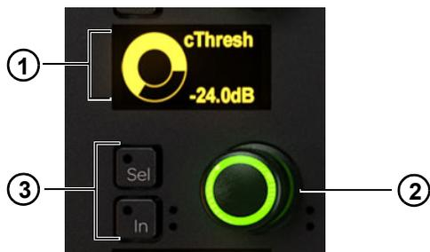
OLED (1), Drehregler (2) und In- und Sel-Schalter (3) für den Regler
